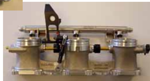
Ein Blick in die Fertigung: Saugöl-pumpe (links) und Drosselklappen-anlage mit Kraftstoffverteiler (unten)
