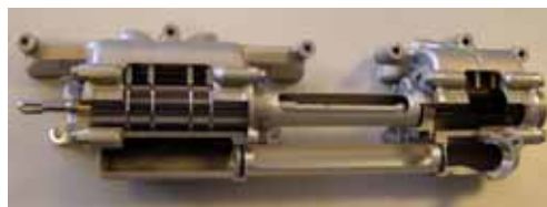
Ein Blick in die Fertigung: Saugöl-pumpe (links) und Drosselklappen-anlage mit Kraftstoffverteiler (unten)
